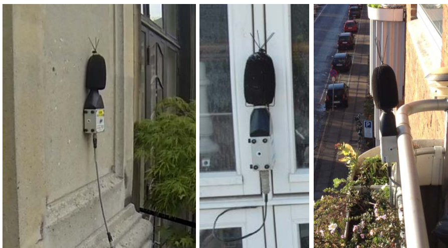
Figur 3 De tre opsætningstyper som CMT har anvendt.
