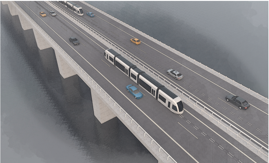
Eksempel på en ca. 30 meter lang selvkørende ART, som følger en stiplede afmærkning i asfalten.
