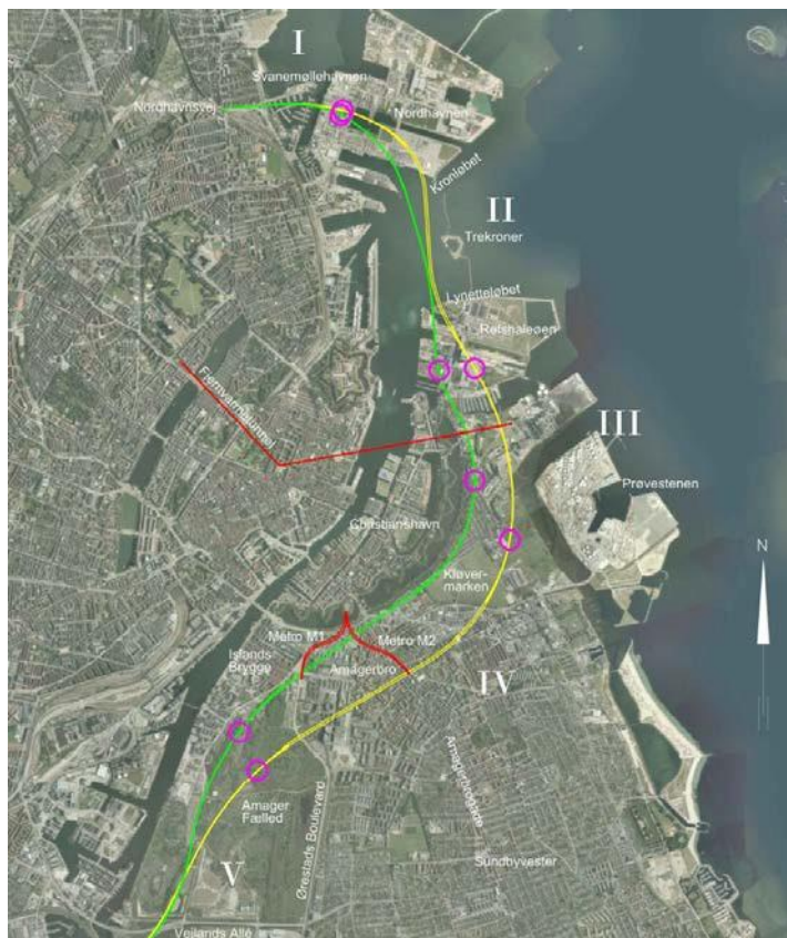
Figur 5-1 Oversigts kort med de undersøgte linjeføringer samt Metro M1 og M2 samt Fjernvarmetunnelen indtegnet i rødt
