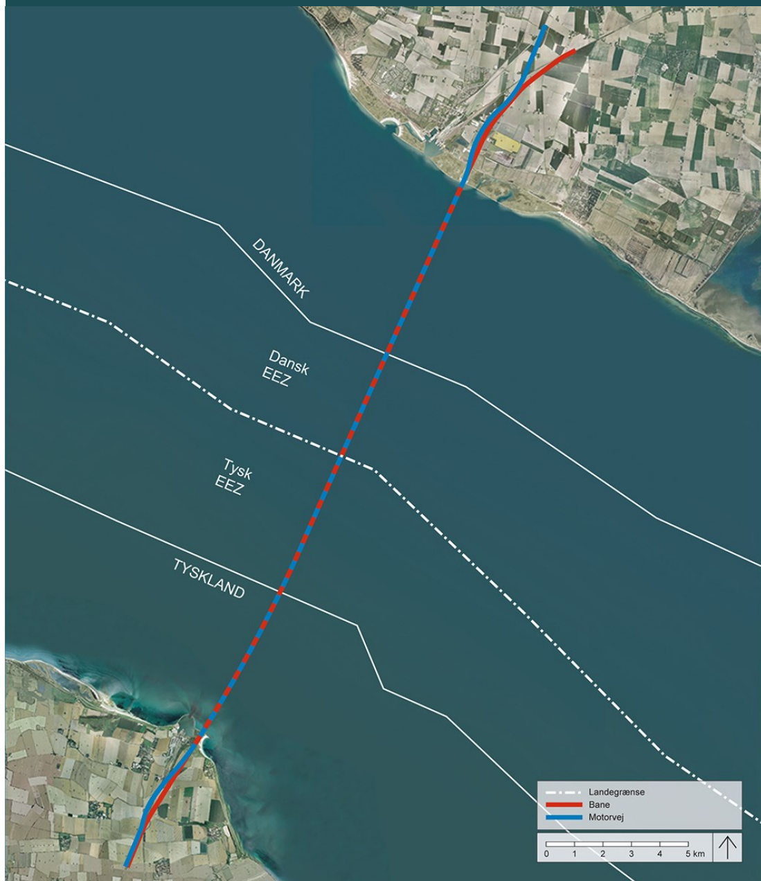
FIGUR 4.11 Forslag til linjeføring for den faste forbindelse over Femern Bælt – sænketunnel
