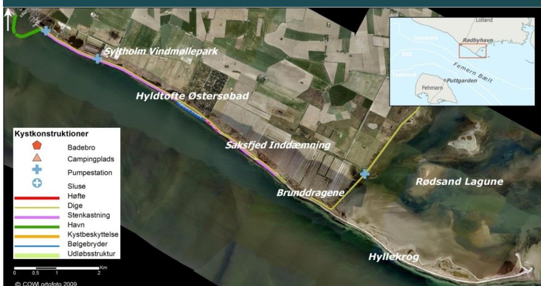
FIGUR 10.1.4-9 Oversigt over kystkonstruktioner mellem Rødbyhavn og Hyllekrog
